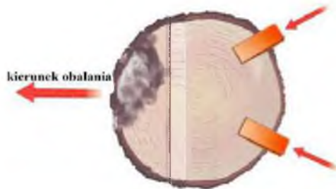
Rys.31 Umieszczenie klinów przy obalaniu drzewa z murszem zewnętrznym
